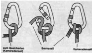
Links ist der HMS Karabiner mit eingelegtem Seil. HMS bedeutet. Halbmastwurf. Diese Art der Sicherung ist auch noch heute im Alpinklettern geläufig, da wenig Material benötigt wird.
